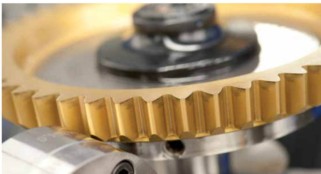
Wysokiej jakości uzębienie przekładni gwarantuje niewielką zużywalność i cichą pracę – nawet przy dużym obciążeniu.
